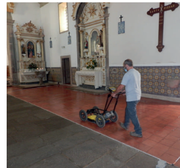
Figura 5 — Prospecção do subsolo no interior da igreja com o georradar | Foto: Victor Bandeira |
